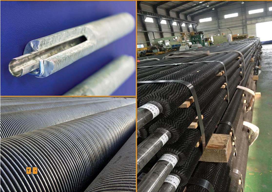
با تکمیل خط تولید کارخانه و خرید دستگاه‌های پره زنی لوله‌های کروم-مولیبدن، خمکاری و ماشین کاری، تولید بویلر های بازیافت حرارتی به عنوان محصول اصلی کارخانه ماشین سازی لرستان انتخاب شد. این ماشین آلات با برند JTC کره جنوبی به همراه قرارداد انتقال کامل دانش و تکنولوژی تولید به کشور وارد شده است.
